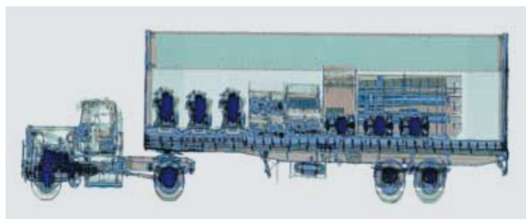
Scanner pour l'inspection du fret à rayons X
